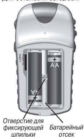
1. Снимите крышку батарейного отсека. Для этого поверните D-образное кольцо на 1/4 оборота против часовой стрелки и затем потяните крышку на себя.
